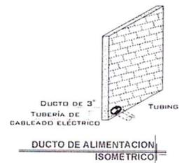
LA DISTANCIA "B" SE CUBRIRÁ DE SER POSIBLE CON DUCTOS REALIZADOS CON TUBERÍA Y LA SALIDA EN EL FONDO SERÁ RECOMENDABLE UBICARLA DEL LADO DONDE SE ENCONTRARÁN LAS COLUMNAS Y EL RESTO DE LA ESTRUCTURA DEL ELEVADOR. EN CASO DE QUE NO SE PUEDA INSTALAR ESTOS DUCTOS SE EMPLEARÁ UNA CANALIZACIÓN DIFERENTE QUE PROTEJA EL CABLEADO, EN CUALQUIERA DE LOS DOS CASOS ESTÁ SERÁ SUMINISTRADA POR PARTE DE TECNOGRAMA Y LOS TRABAJOS PARA SU INSTALACIÓN LO HARÁ EL EQUIPO DE LA EMPRESA.
