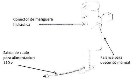
Paso 8: Conectar las mangueras hidraulicas a los cilindros
