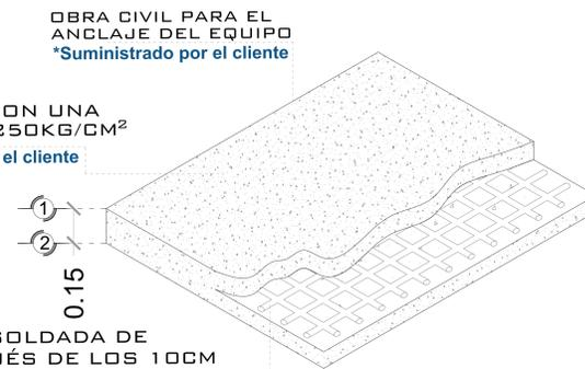
**ARMADO DE FIRME ISOMETRICO**
