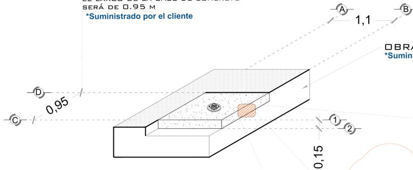
**FIRME DE CONCRETO PARA ELEVADOR ISOMETRICO**
