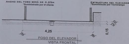
OBRA CIVIL PARA EL ANCLAJE DEL EQUIPO
