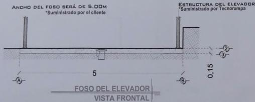
OBRA CIVIL PARA EL ANCLAJE DEL EQUIPO
