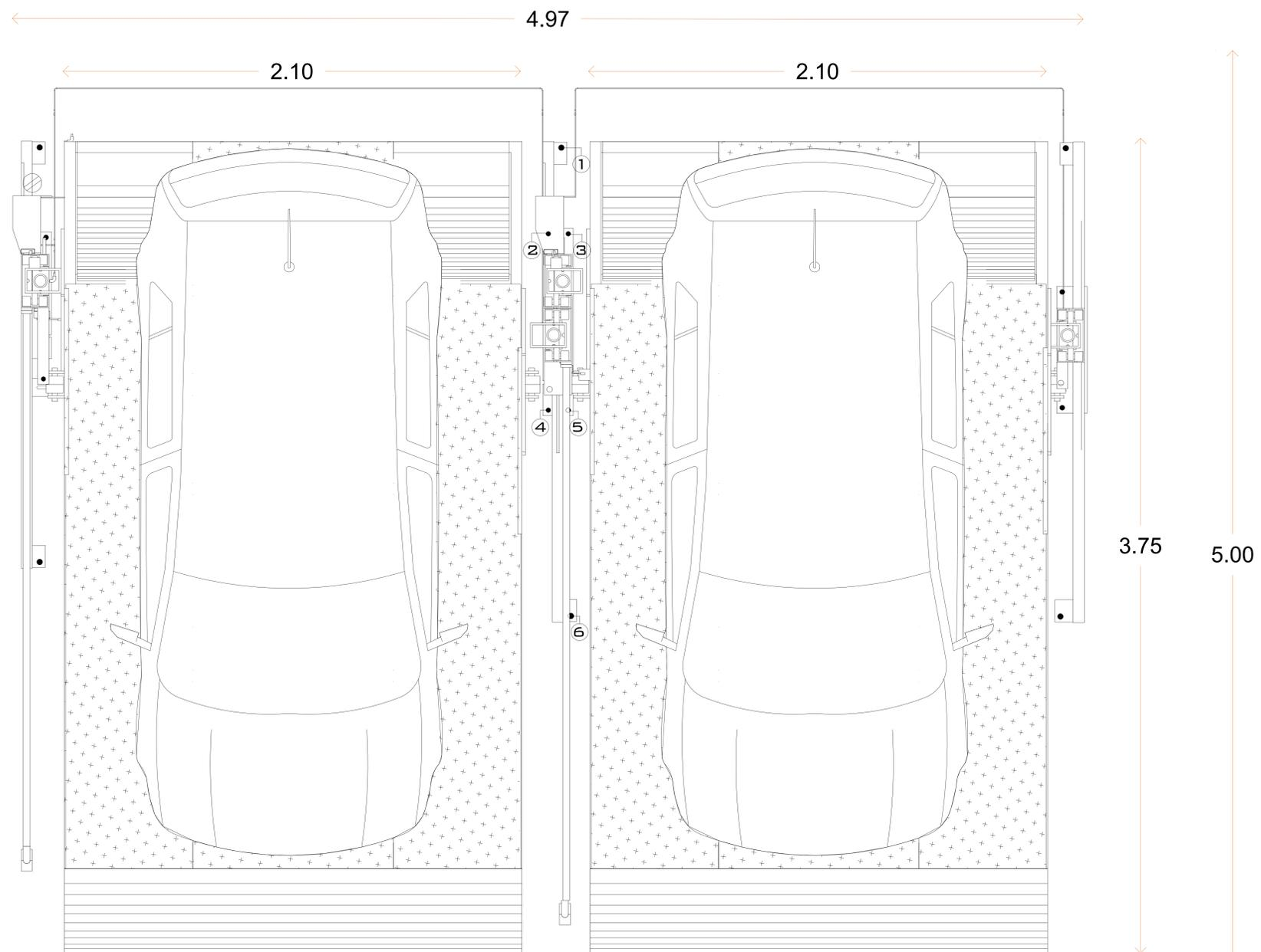
EL MODELO QUE PROPONEMOS MANEJAR PARA EL ÁREA DE LOS CAJONES SON RAMPAS TR EVOLUTION EMPATADAS CON PLATAFORMA DE 2.10M X 3.75M, LAS CUALES FUNCIONAN DE MANERA COMPLETAMENTE INDEPENDIENTE ENTE ELLAS, CON ELLO QUEDA UN MAYOR ESPACIO ENTRE CAJÓN Y CAJÓN.
