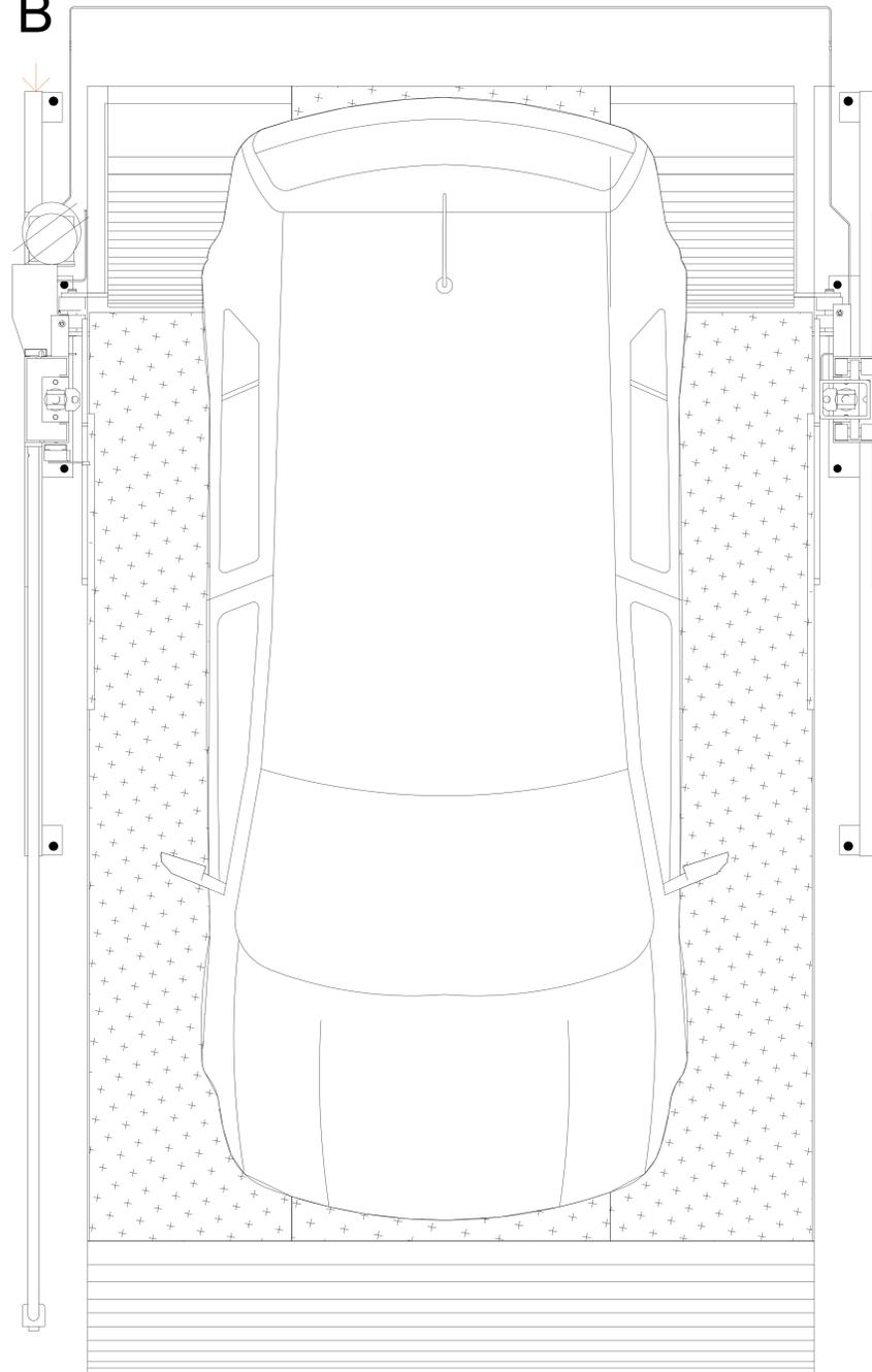
LA UNIDAD HIDRÁULICA SE UBICARÁ SOBRE LA COLUMNA DE LADO IZQUIERDO DE LA MISMA, POR LO QUE SERÁ NECESARIA LA COLOCACIÓN POR PARTE DEL CLIENTE DE UNA CAJA DE REGISTRO.
