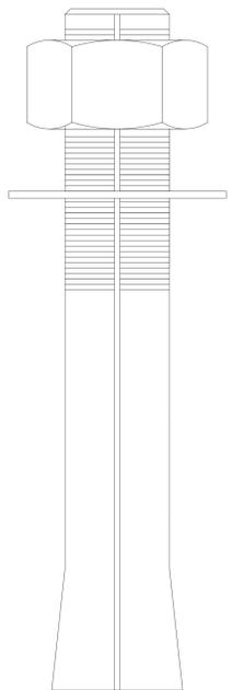
PARA LA CORRECTA INSTALACIÓN DEL EQUIPO ES NECESARIO COLOCAR TAQUETES EXPANSIVOS DE  $\frac{3}{4}$ " X  $4\frac{3}{4}$ " PARA EL ANCLAJE DE COLUMNAS CON EL FIRME. POR LO QUE SE REQUIERE UNA BASE DE CONCRETO ARMADA CON MALLA ELECTROSOLDADA 6.6.10.10 DONDE SE DEBERÁ DE UTILIZAR UN CONCRETO CON UNA RESISTENCIA F' C 250KG/CM2 Y UN ESPESOR DE 0.15M.
