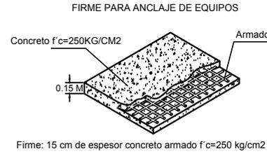
Firme: 15 cm de espesor concreto armado f'c=250 kg/cm2
