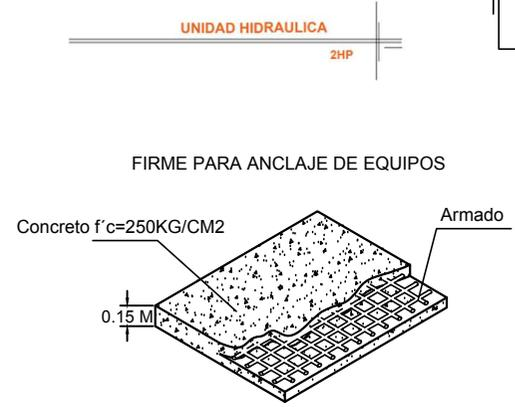
Firme: 15 cm de espesor concreto armado f'c=250 kg/cm2
