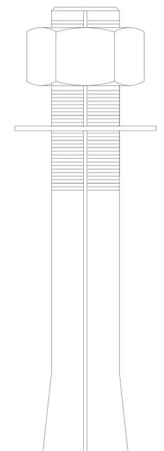
PARA LA CORRECTA INSTALACIÓN DEL EQUIPO ES NECESARIO COLOCAR TAQUETES EXPANSIVOS DE  $\frac{3}{4}$ " X  $4\frac{3}{4}$ " PARA EL ANCLAJE DE COLUMNAS CON EL FIRME. POR LO QUE SE REQUIERE UNA BASE DE CONCRETO ARMADA CON MALLA ELECTROSOLDADA 6.6.10.10 DONDE SE DEBERÁ DE UTILIZAR UN CONCRETO CON UNA RESISTENCIA F' C 250KG/CM2 Y UN ESPESOR DE 0.15M.
