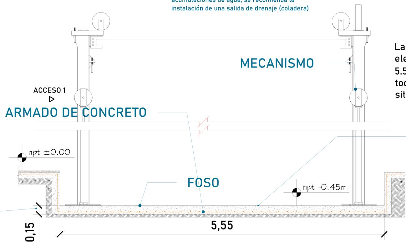
Firme de concreto armado con una resistencia de  $F'c = 250 \text{ kg/cm}^2$ .
