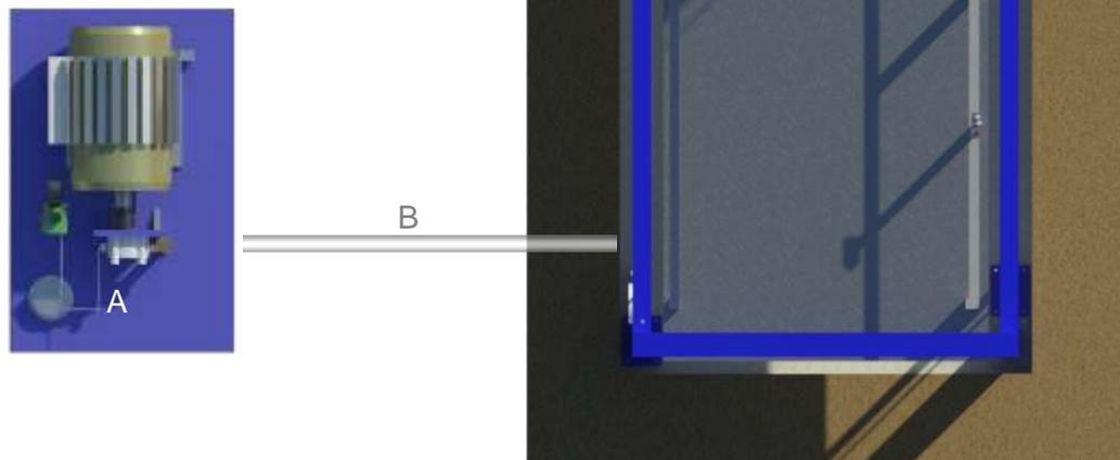
**NOTA:** La distancia B se cubrirá de ser posible con ductos realizados con tubería, y la salida en el foso será recomendable ubicarla del lado donde se encontraran las columnas y el resto de la estructura del elevador. En caso de que no se pueda instalar estos ductos se empleara una canalización diferente que proteja el cableado. En cualquiera de los dos casos esta será suministrada por parte de Tecno Rampa, y los trabajos para su instalación lo hará el equipo de la empresa.
