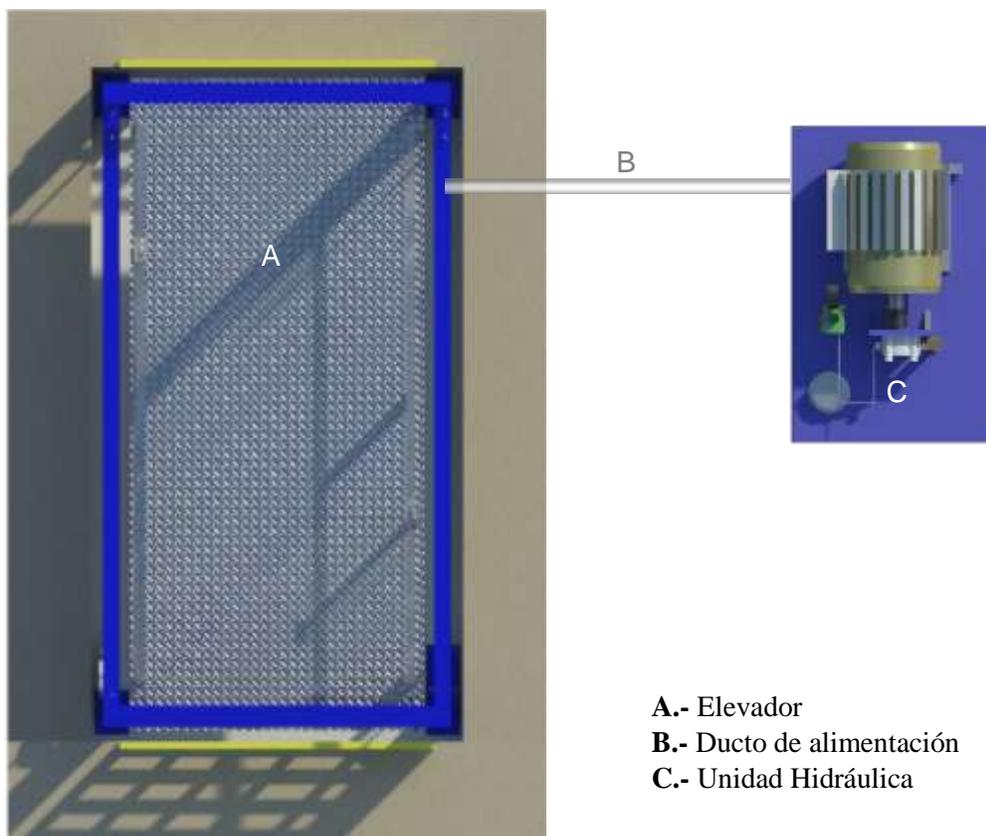
**NOTA:** La distancia B se cubrirá de ser posible con ductos realizados con tubería, y la salida en el foso será recomendable ubicarla del lado donde se encontraran las columnas y el resto de la estructura del elevador. En caso de que no se pueda instalar estos ductos se empleara una canalización diferente que proteja el cableado. En cualquiera de los dos casos esta será suministrada por parte de Tecno Rampa, y los trabajos para su instalación lo hará el equipo de la empresa.
