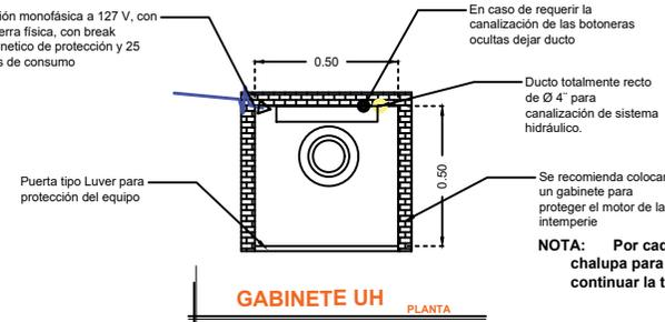
**NOTA:** Por cada nivel adicional deberá de colocar una chalupa para alojar el botón de llamado y debería de continuar la tubería hasta esta.
