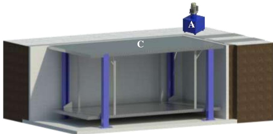
La unidad hidráulica y control eléctrico deberán ser instalados fuera del foso y ubicarse en un lugar libre de polvo, líquidos e inclemencias del clima, evitando que se contamine el aceite y se pierda la garantía del equipo.
