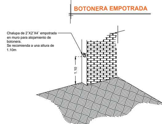
\*Tubería y registro eléctricos suministrados por el cliente, únicamente ductería sin cableado ( DEJAR GUIA EN LA CANALIZACIÓN)
