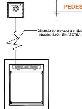
**NOTA:** Por cada nivel adicional deberá de colocar una chalupa para alojar el botón de llamado y deberá de continuar la tubería hasta esta.
