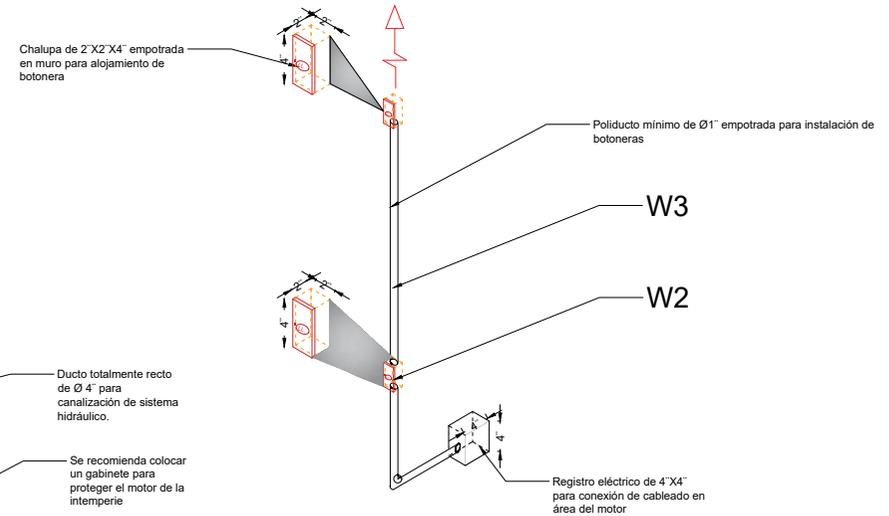
\*Tubería y registro eléctricos suministrados por el cliente, únicamente ductería sin cableado
