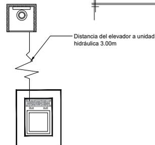
**NOTA:** Por cada nivel adicional deberá de colocar una chalupa para alojar el botón de llamado y debería de continuar la tubería hasta esta.
