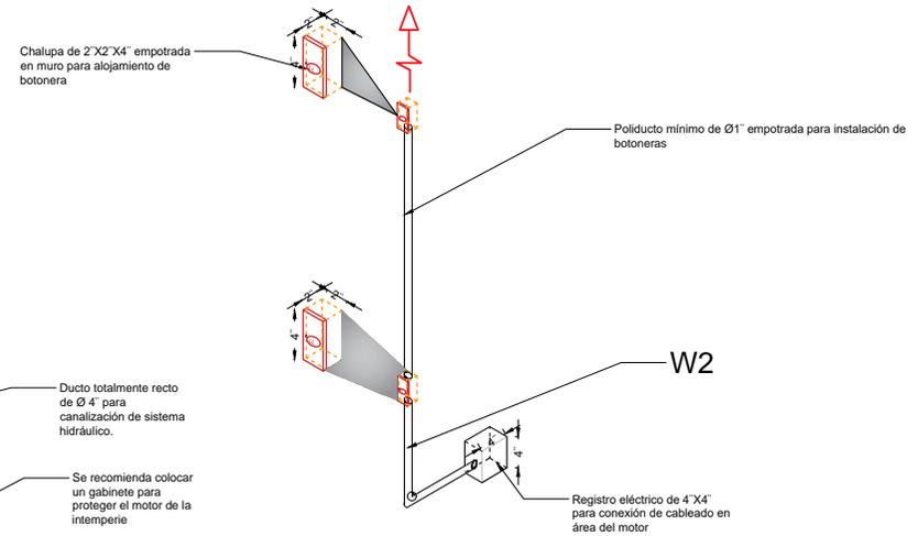
\*Tubería y registro eléctricos suministrados por el cliente, únicamente ductería sin cableado (DEJAR GUIADA LA CANALIZACION)
