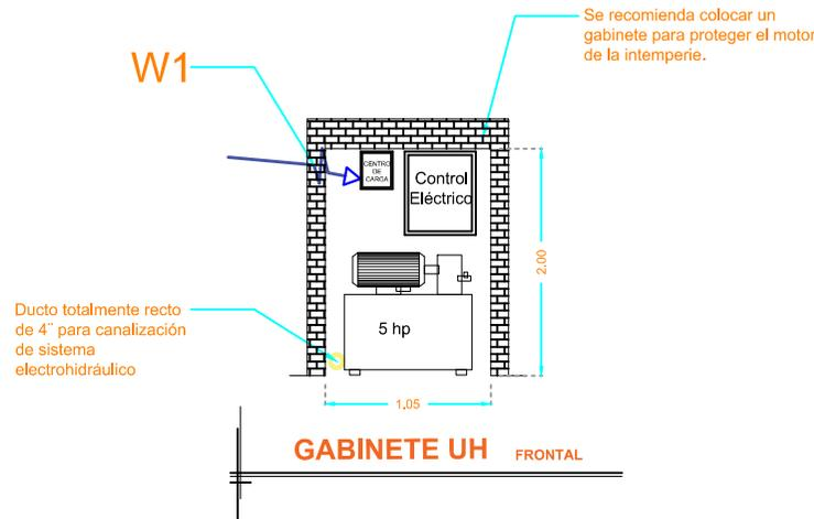
CENTRO DE CARGA Alimentación trifásica a 220 V, con neutro y tierra física, con break termomagnético de protección 3 X 40 Amp libres de consumo
