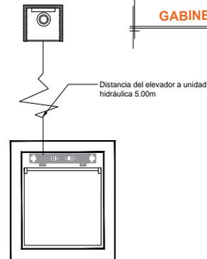
**NOTA:** Por cada nivel adicional deberá de colocar una chalupa para alojar el botón de llamado y debería de continuar la tubería hasta esta.
