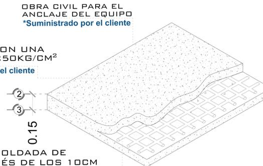
**ARMADO DE FIRME ISOMETRICO**
