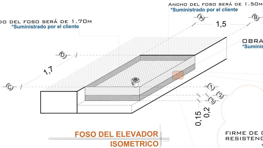
OBRA CIVIL PARA EL ANCLAJE DEL EQUIPO
