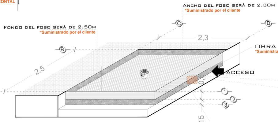
OBRA CIVIL PARA EL ANCLAJE DEL EQUIPO
