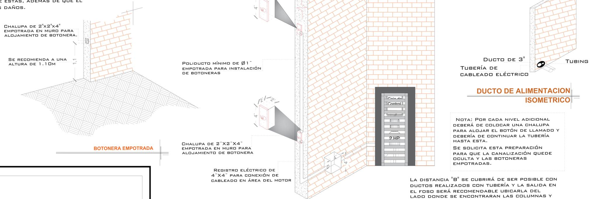
NOTA: POR CADA NIVEL ADICIONAL DEBERÁ DE COLOCAR UNA CHALUPA PARA ALOJAR EL BOTÓN DE LLAMADA Y DEBERÍA DE CONTINUAR LA TUBERÍA HASTA ESTA. SE SOLICITA ESTA PREPARACIÓN PARA QUE LA CANALIZACIÓN QUEDE OCULTA Y LAS BOTONERAS EMPOTRADAS.
