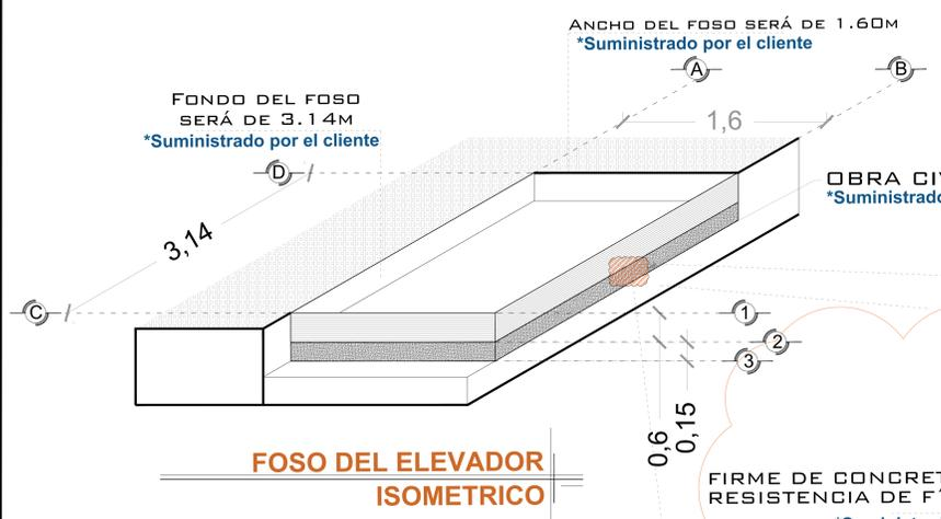
OBRA CIVIL PARA EL ANCLAJE DEL EQUIPO
