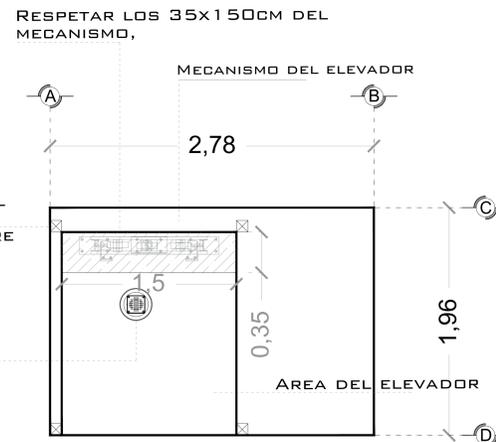
NOTA: REFUERZO A 1.80M, YA QUE LAS COLUMNAS DEL ELEVADOR MARCA TECNORAMPA SOBRE SALEN 1.80M DESPUES DE LA ULTIMA ESTACIÓN
