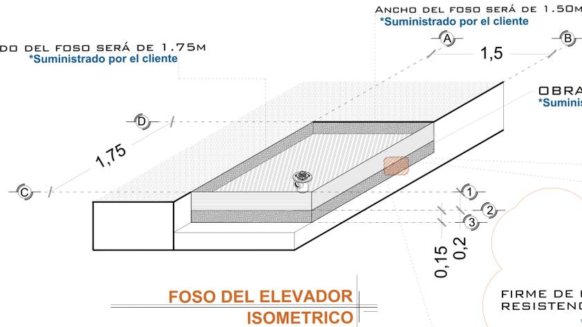
OBRA CIVIL PARA EL ANCLAJE DEL EQUIPO
