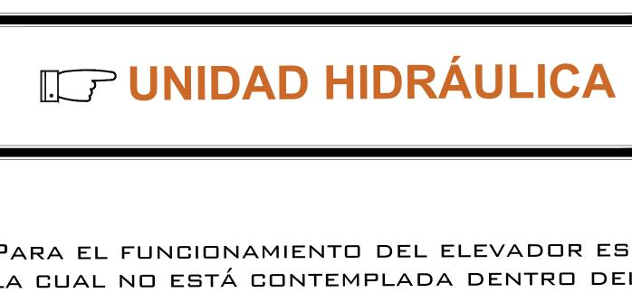
PARA EL FUNCIONAMIENTO DEL ELEVADOR ES NECESARIA UNA UNIDAD HIDRÁULICA, LA CUAL NO ESTÁ CONTEMPLADA DENTRO DEL CLARO DEL ELEVADOR, SE LE DA LA OPCIÓN AL CLIENTE QUE DECIDA EL LUGAR DE LA UNIDAD. SE REQUIERE COLOCAR UN NICHO PARA ALOJAR LA UNIDAD HIDRÁULICA Y EL CONTROL ELÉCTRICO TENIENDO UN ACCESO PARA SU MANTENIMIENTO.
