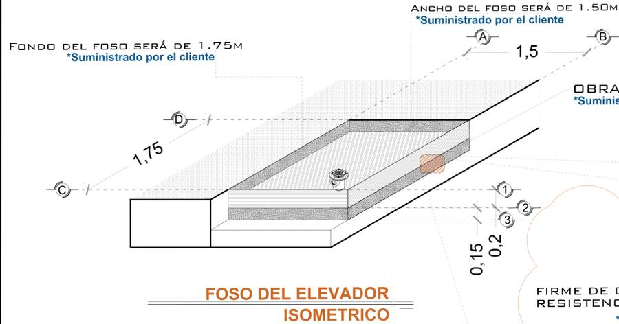
OBRA CIVIL PARA EL ANCLAJE DEL EQUIPO
