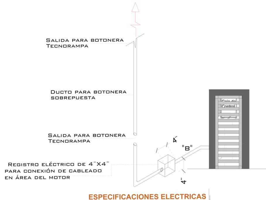
LA DISTANCIA "B" SE CUBRIRÁ DE SER POSIBLE CON DUCTOS REALIZADOS CON TUBERÍA Y LA SALIDA EN EL FOSO SERÁ RECOMENDABLE UBICARLA DEL LADO DONDE SE ENCONTRARAN LAS COLUMNAS Y EL RESTO DE LA ESTRUCTURA DEL ELEVADOR. EN CASO DE QUE NO SE PUEDA INSTALAR ESTOS DUCTOS SE EMPLEARA UNA CANALIZACIÓN DIFERENTE QUE PROTEJA EL CABLEADO. EN CUALQUIERA DE LOS DOS CASOS ESTÁ SERÁ SUMINISTRADA POR PARTE DE TECNORAMPA Y LOS TRABAJOS PARA SU INSTALACIÓN LO HARÁ EL EQUIPO DE LA EMPRESA.
