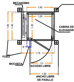
ESTRUCTURA SUMINISTRADA POR EL CLIENTE. EN ESTA PLANTA SE MARCA UN HSS DE 8" X 8", SIN EMBARGO SE DEJA A CONSIDERACIÓN Y CALCULO DEL CLIENTE, DE CAMBIAR LA DIMENSIÓN MENCIONADA, SE DEBERÁN DE REAJUSTAR LAS DIMENSIONES MARCADAS DEL EQUIPO, FAVOR DE DAR AVISO A TECNORAMPA.
