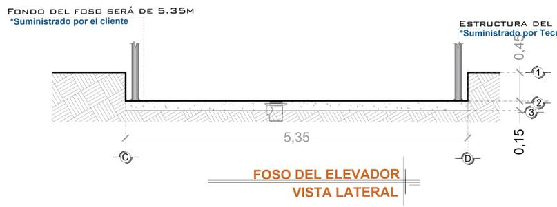
POR MOTIVO DE SEGURIDAD ANTE POSIBLES ACUMULACIONES DE AGUA, COMO INUNDACIONES O FUGAS, SE RECOMIENDA LA INSTALACIÓN UNA SALIDA DE TUBERÍA DE DRENAJE (COLADERA) PARA DESALOJAR EL AGUA QUE SE PUDIERA ALMACENAR EN EL FOSO, DICHA TUBERÍA SE CONECTARA A LA RED DE DRENAJE O ÁREAS VERDES SEGÚN LA DECISIÓN DEL CLIENTE.
