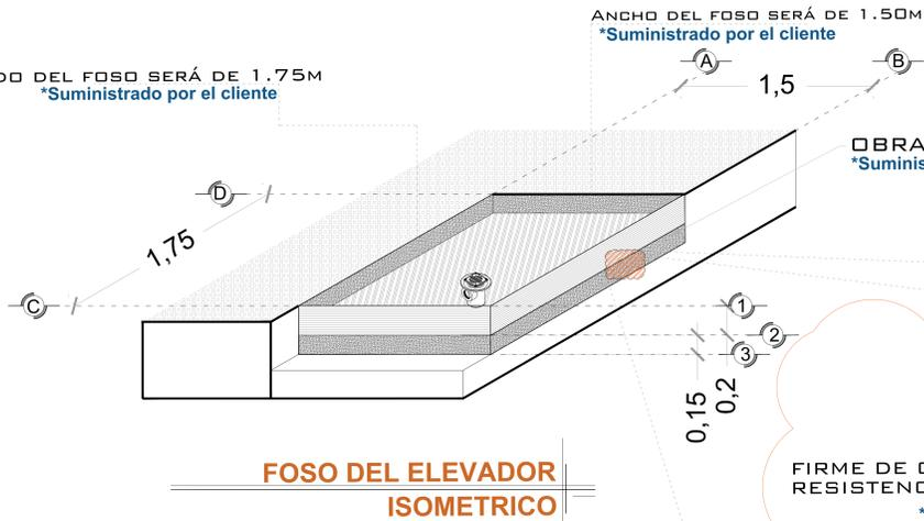
OBRA CIVIL PARA EL ANCLAJE DEL EQUIPO
