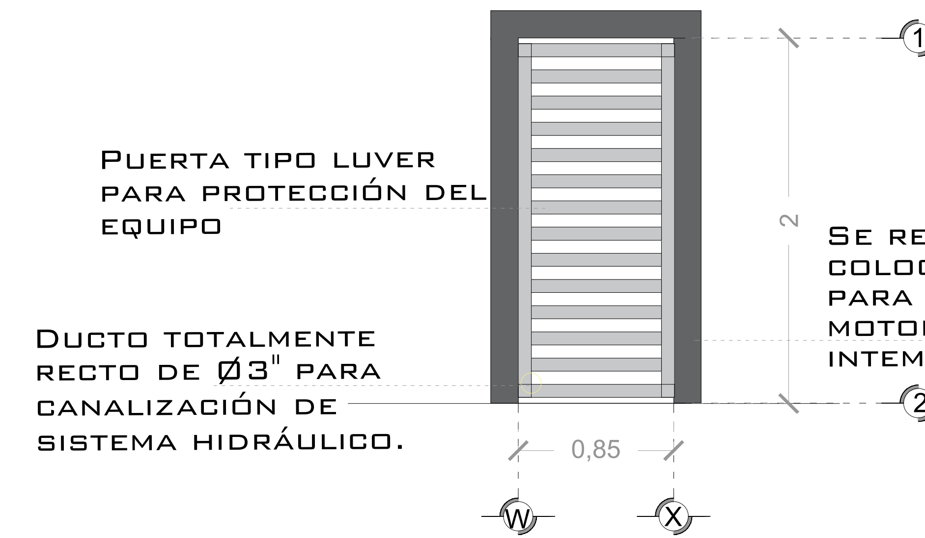
DESCRIPCION DE UNIDAD HIDRAULICA GABINETE (VISTA FRONTAL)
