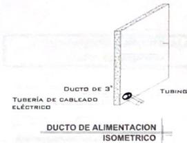
LA DISTANCIA "B" SE COBRIRÁ DE SER POSIBLE CON DUCTOS REALIZADOS CON TUBERÍA Y LA SALIDA EN EL FONDO SERÁ RECOMENDABLE UBICARLA DEL LADO DONDE SE ENCONTRARÁN LAS COLUMNAS Y EL RESTO DE LA ESTRUCTURA DEL ELEVADOR. EN CASO DE QUE NO SE PUEDA INSTALAR ESTOS DUCTOS SE EMPLEARÁ UNA CANALIZACIÓN DIFERENTE QUE PROTEJA EL CABLEADO. EN CUALQUIERA DE LOS DOS CASOS ESTÁ SERÁ SUMINISTRADA POR PARTE DE TECNORAMPA Y LOS TRABAJOS PARA SU INSTALACIÓN LO HARÁ EL EQUIPO DE LA EMPRESA.
