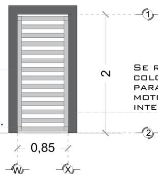
DUCTO TOTALMENTE RECTO DE Ø3" PARA CANALIZACIÓN DE SISTEMA HIDRÁULICO.
