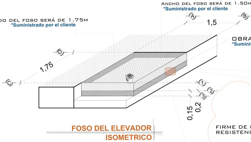
OBRA CIVIL PARA EL ANCLAJE DEL EQUIPO
