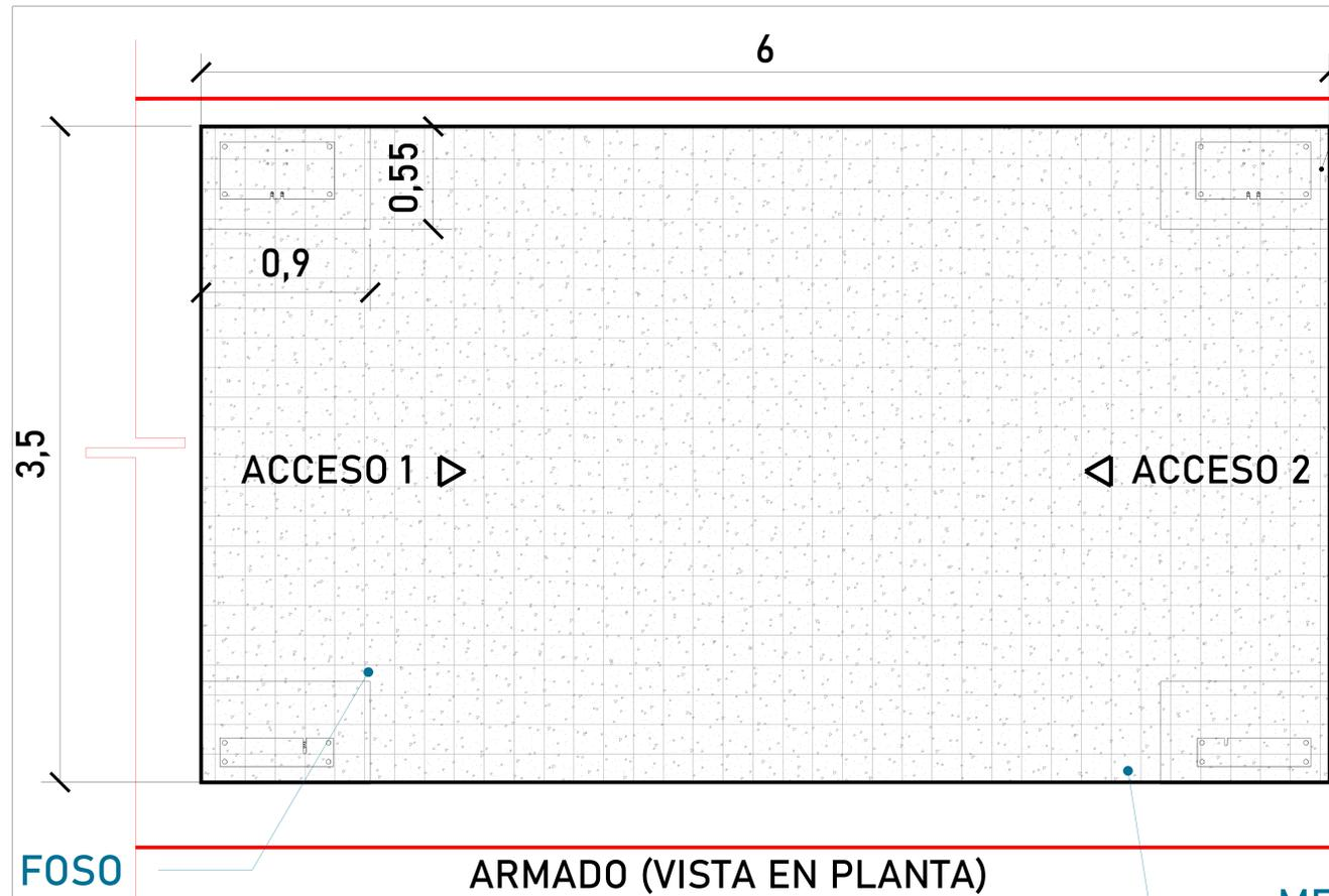
Placa de  $\frac{1}{2}$ " de 0.55mx 0.90m, ahogada en piso para la correcta instalacion de las columnas del equipo Tecnorampa
