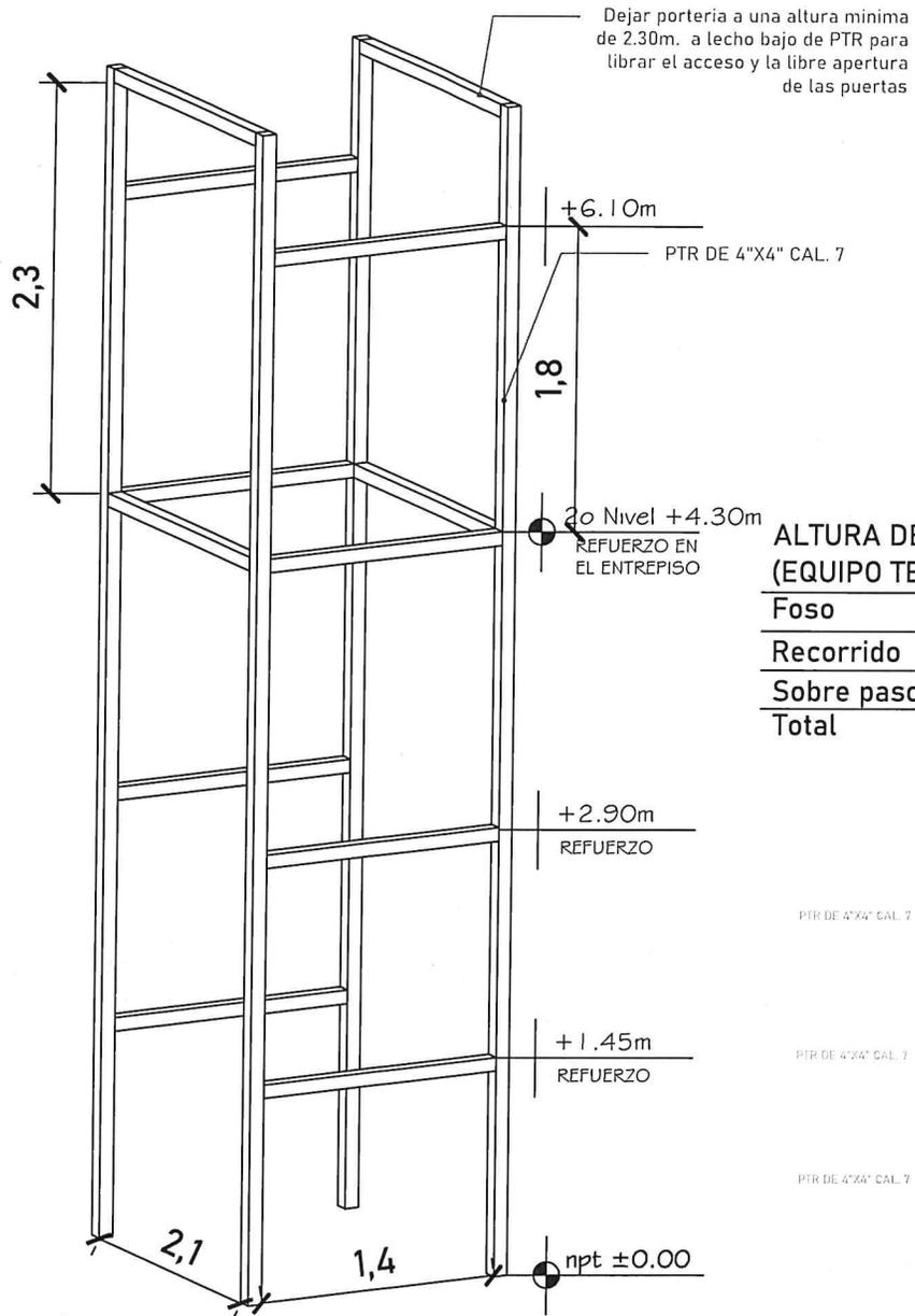
Para la estabilidad del equipo Tecnorampa debera ser anclado aun cierto numero de refuerzos estos serán de acuerdo al recorrido del equipo y a los distintos niveles que se tengan. En la parte alta de la estructura se solicita un refuerzo a 1.80m y del lado de los accesos se solicita una porteria de 2.30 libres, esto para no interferir con la puerta y pueda abrir sin ningún inconveniente.
