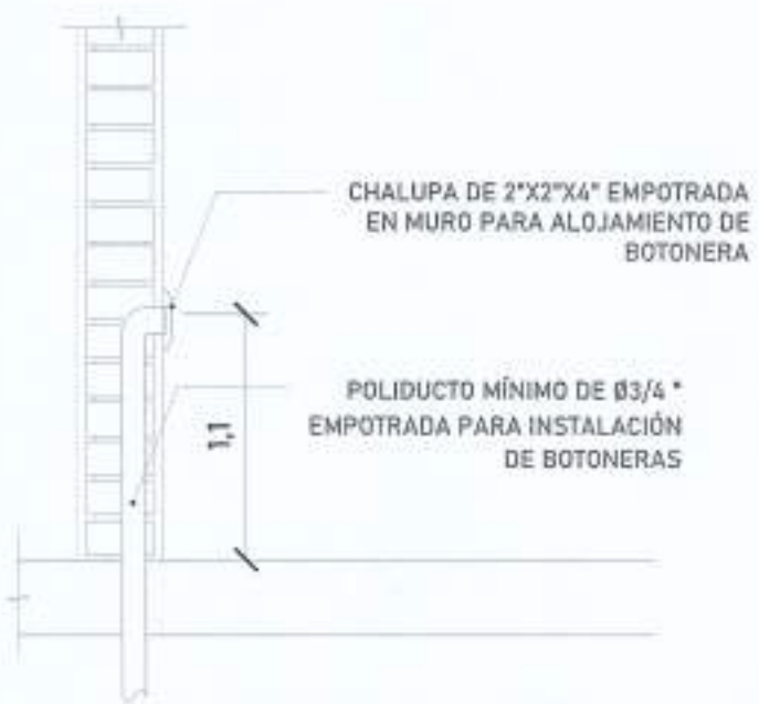
BOTONERA EN PEDESTAL EN PLANTA BAJA BOTONERA EMPOTRADA EN PLANTA ALTA
