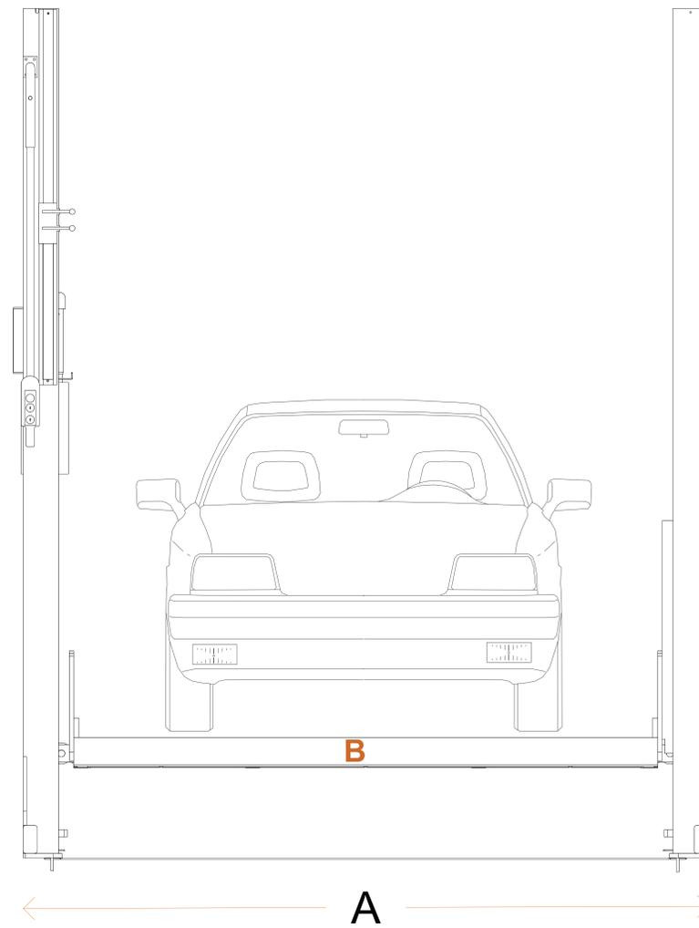
**A** ANCHO CAJÓN DE ESTACIONAMIENTO 2.55M
