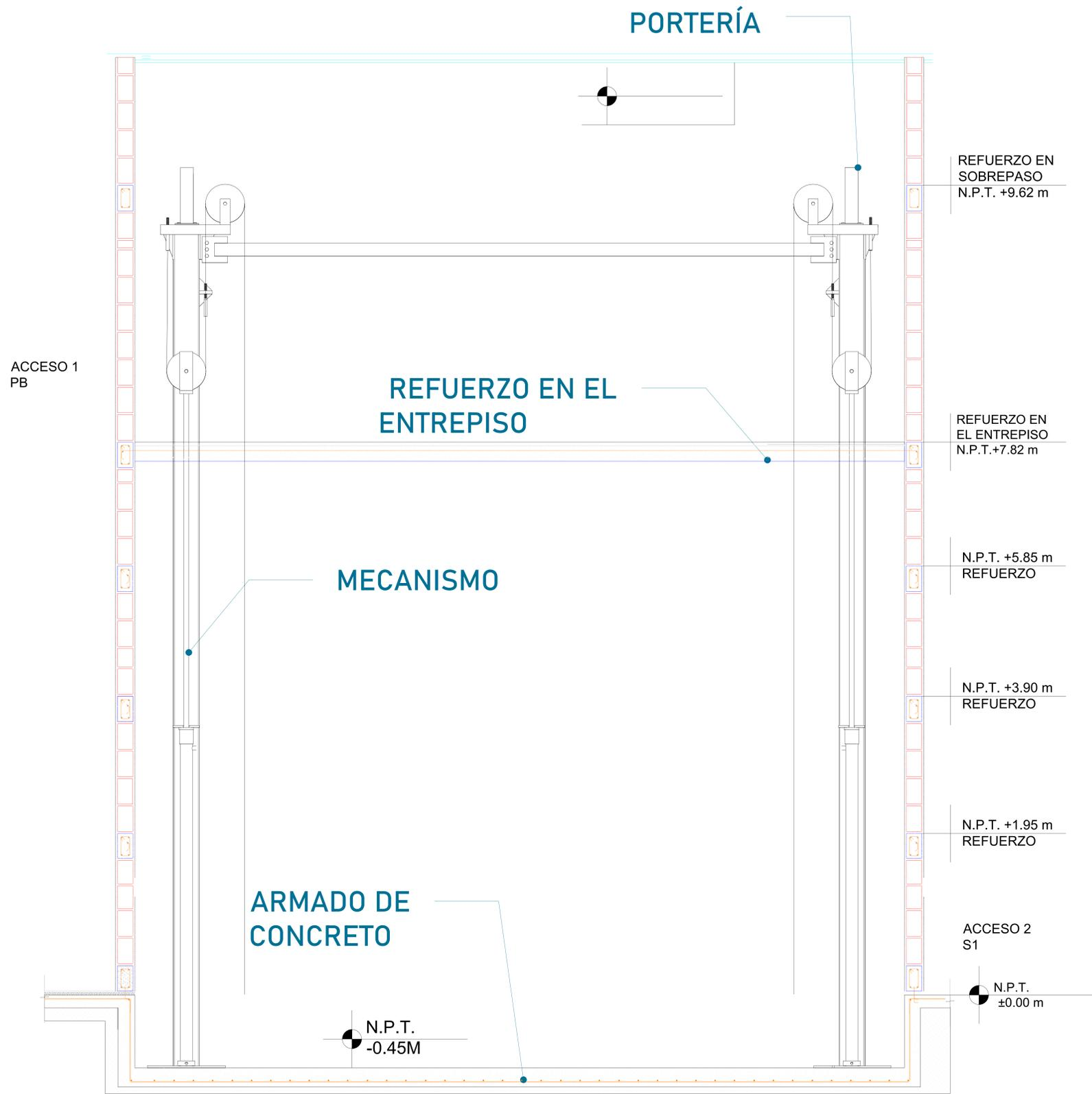
Para la estabilidad del equipo Tecnorampa debera ser anclado aun cierto numero de refuerzos estos serán de acuerdo al recorrido del equipo y a los distintos niveles que se tengan. Para anclar se solicita una cadena de concreto ( $f'c=250 \text{ kg/cm}^2$ ) o una viga de acero, ambas minimo de 15 cm. En la ultima estación nuestras columnas tienen un sobrepaso de 1.80m por lo tanto se solicita un refuerzo a esa altura.
