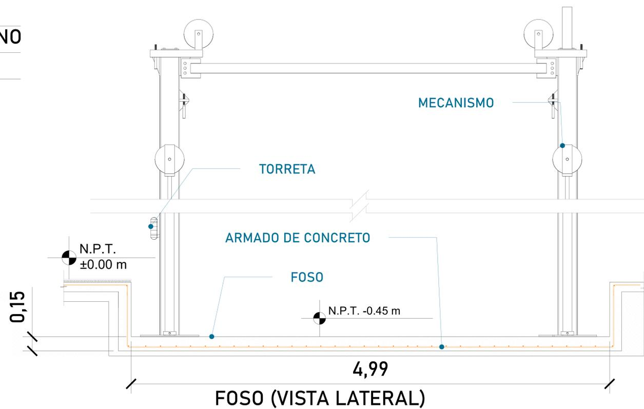
Firme de concreto con una resistencia de  $f'c=250kg/cm^2$
