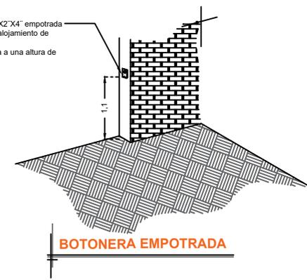
**NOTA:** Por cada nivel adicional deberá de colocar una chalupa para alojar el botón de llamado y debería de continuar la tubería hasta esta.
