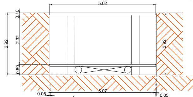
CORTE DE UNDER RAMP (Altura de foso 2.92 m) EQUIPO No. 1 (Segun sembrado Proyecto Irapuato No. 13)
