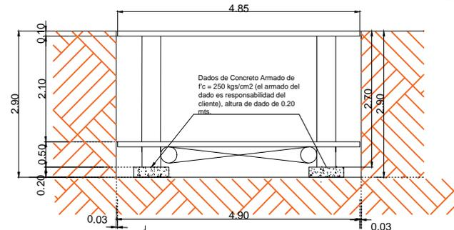
**CORTE DE UNDER RAMP** (Altura de foso 2.90 m) EQUIPO No. 4 (Segun sembrado Proyecto Irapuato No. 13)
