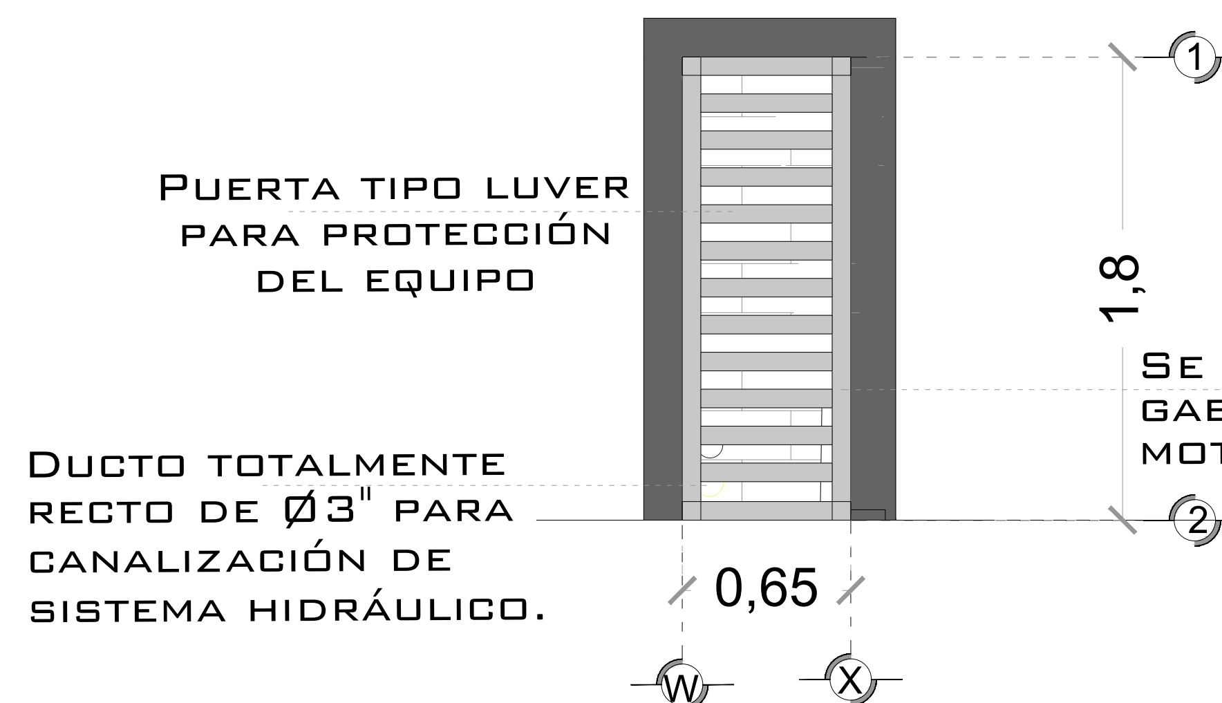
DESCRIPCION DE UNIDAD HIDRAULICA GABINETE (VISTA FRONTAL)
