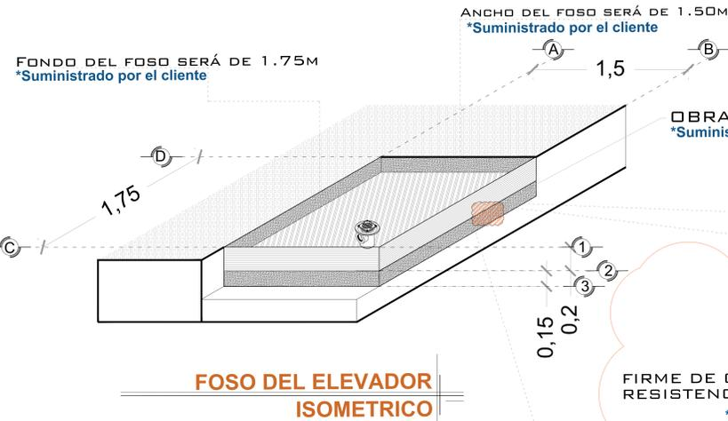
OBRA CIVIL PARA EL ANCLAJE DEL EQUIPO
