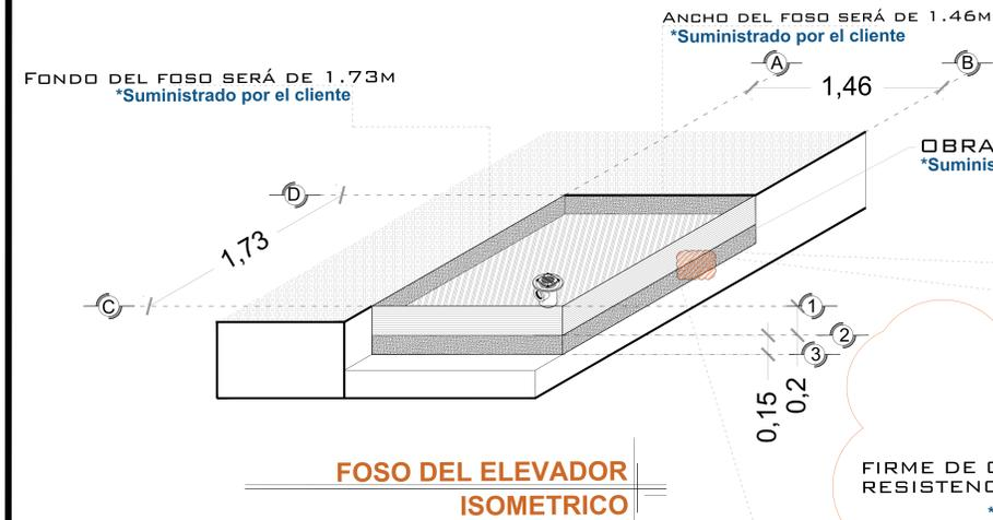
OBRA CIVIL PARA EL ANCLAJE DEL EQUIPO
