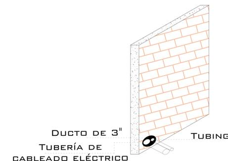
LA DISTANCIA "B" SE CUBRIRÁ DE SER POSIBLE CON DUCTOS REALIZADOS CON TUBERÍA Y LA SALIDA EN EL FOSO SERÁ RECOMENDABLE UBICARLA DEL LADO DONDE SE ENCONTRARÁN LAS COLUMNAS Y EL RESTO DE LA ESTRUCTURA DEL ELEVADOR. EN CASO DE QUE NO SE PUEDA INSTALAR ESTOS DUCTOS SE EMPLEARA UNA CANALIZACIÓN DIFERENTE QUE PROTEJA EL CABLEADO. EN CUALQUIERA DE LOS DOS CASOS ESTÁ SERÁ SUMINISTRADA POR PARTE DE TECNORAMPA Y LOS TRABAJOS PARA SU INSTALACIÓN LO HARÁ EL EQUIPO DE LA EMPRESA.
