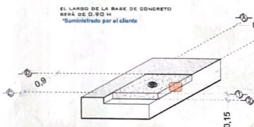
FIRME DE CONCRETO PARA ELEVADOR ISOMETRICO
